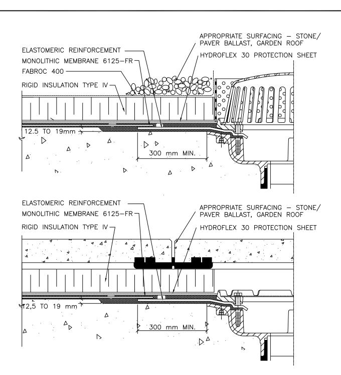
NOTES: AREA AROUND DRAIN SHOULD BE DEPRESSED/SUMPED (SEE DRAWING) TO PROMOTE POSITIVE WATER DRAINAGE.
