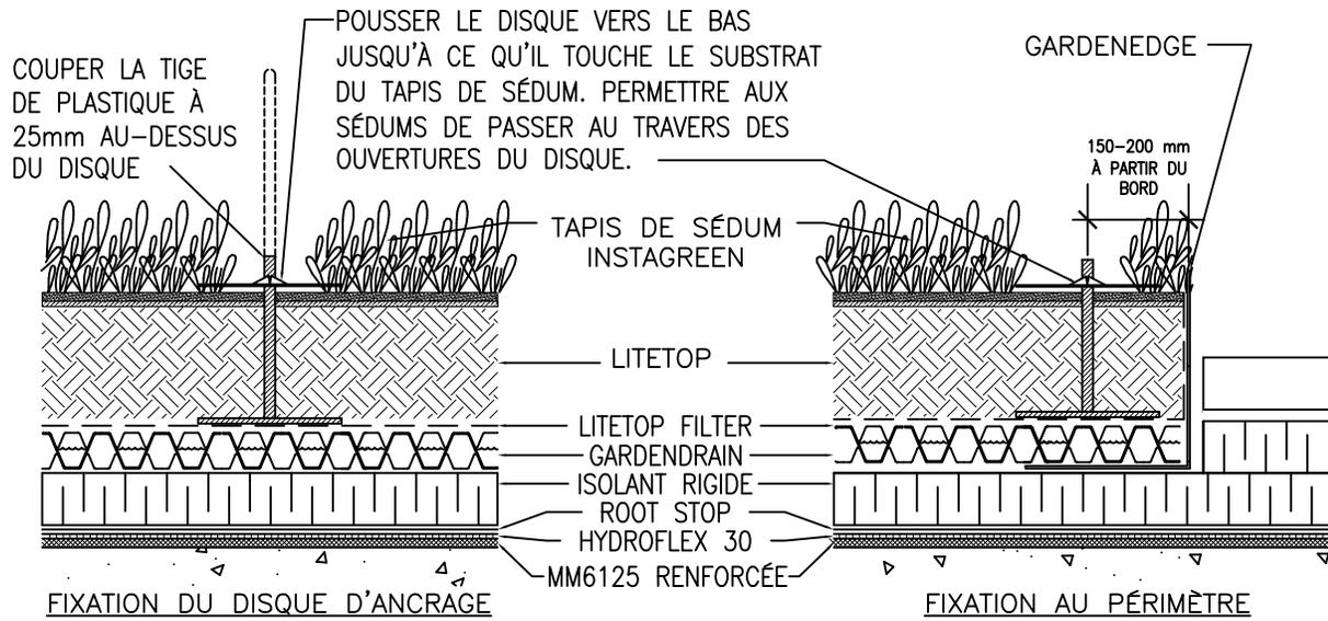
LES TAPIS DE SÉDUM INSTAGREEN INSTALLÉS DANS LA ZONE DE CONTRÔLE DE L'ÉROSION DOIVENT ÊTRE FIXÉS AVEC LES DISQUES D'ANCRAGE.
