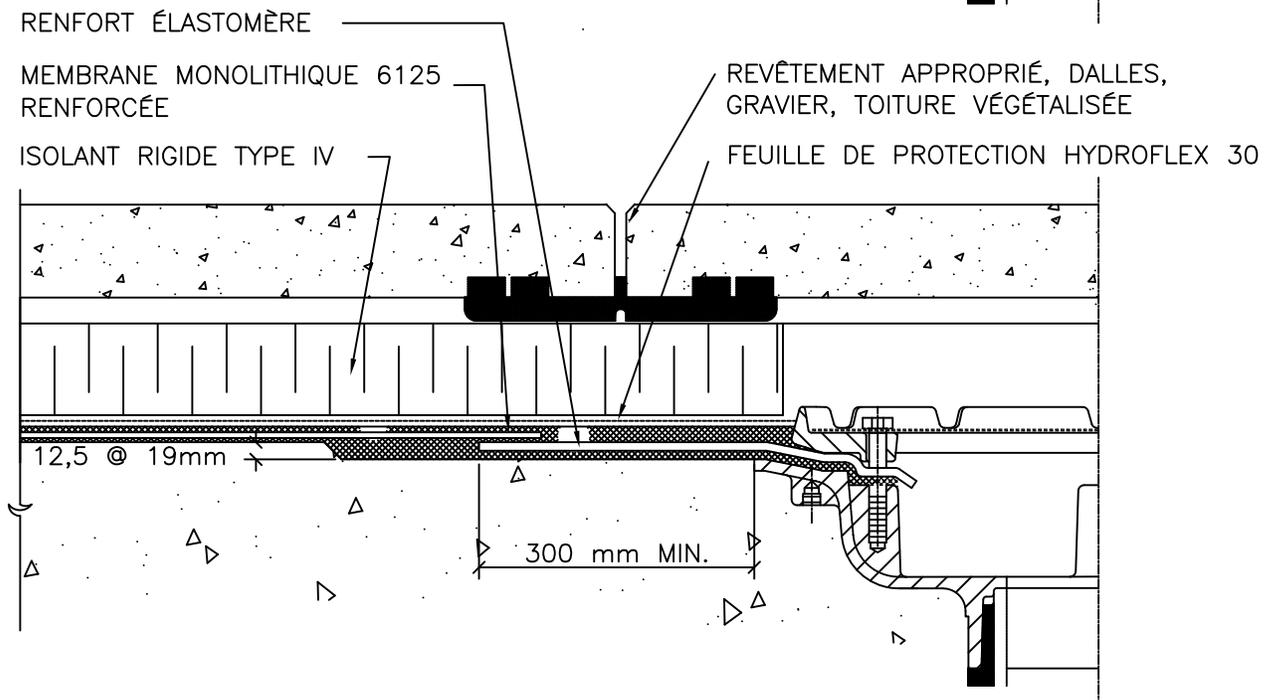
NOTES: LA SURFACE AUTOUR DU DRAIN DOIT ÊTRE ABAISSÉE AFIN DE PERMETTRE AISÉMENT L'ÉCOULEMENT DE L'EAU.
